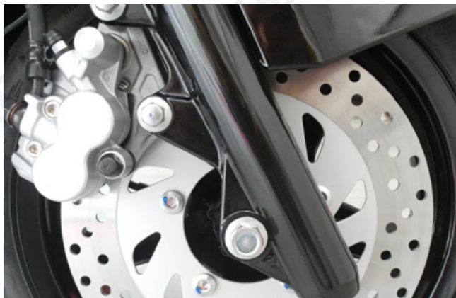
▲ 碟式煞車示意圖。
