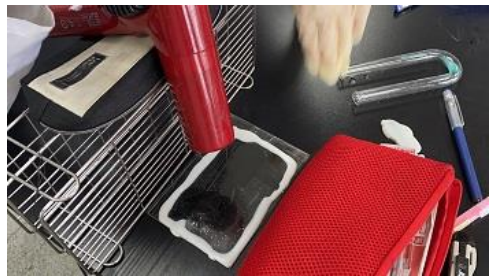
▲ 圖(四)將白膠用吹風機吹乾，加速乾燥
